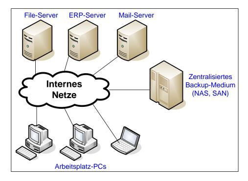
Die klassische Bandsicherung ist heute längst nicht mehr den Anforderungen an eine leistungsfähige Datensicherung gewachsen. Heute setzt man zentralisierte Backup-Medien ein, die im Firmennetzwerk integriert sind und es erlauben, schnelle, effektive Sicherungen aller lebens notwendiger Daten vorzunehmen. Als Beispielt hierzu seien NAS (Network-Attached-Storag oder auch eigenständige SAN-Lösungen (Storage-Area-Network) aufgeführt.
