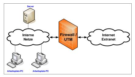
Die Rechner eines Netzwerkes verbinden sich zentral über eine Firewall mit dem Internet. Der gesamte Datenverkehr ins Netzwerk und aus dem Netzwerk heraus wird nun von dieser gefiltert und die einzelnen Datenpakete auf ihre Sicherheitskriterien hin überprüft. Stimmt der Inhalt der Datenpakete nicht mit den Sicherheitskriterien überein, so werden diese Pakete durch die Firewall gesperrt.
