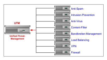
Eine UTM-Firewall ist viel mehr als nur eine Firewall - sie vereint verschiedene Sicherheitslösungen in ein und demselben Gerät und bietet damit ein Höchstmaß an Sicherheit bei zentraler Verwaltung.
